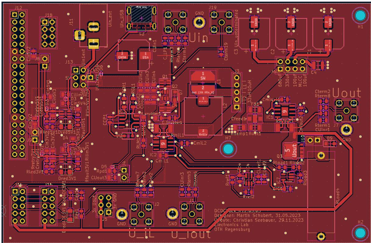
Fig. 1.4(a): DCDCbuck\_R12.03 front-side copper layer (KiCad [19])
