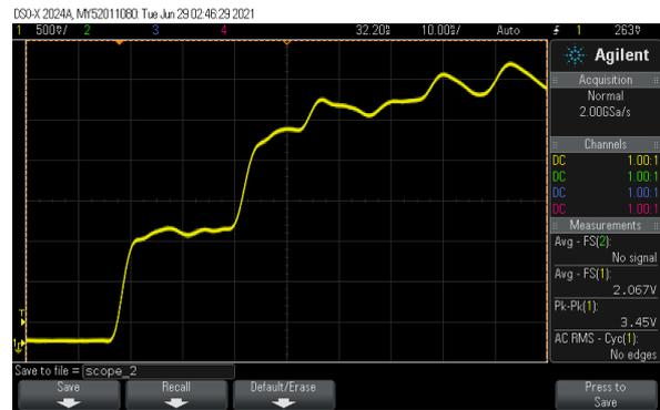
**Bild 6 (a):** Messaufbau, **(b)** Schalter  $S$  offen: Messung an  $n_2$  ohne  $TLine2$  und  $TLine3$ .
