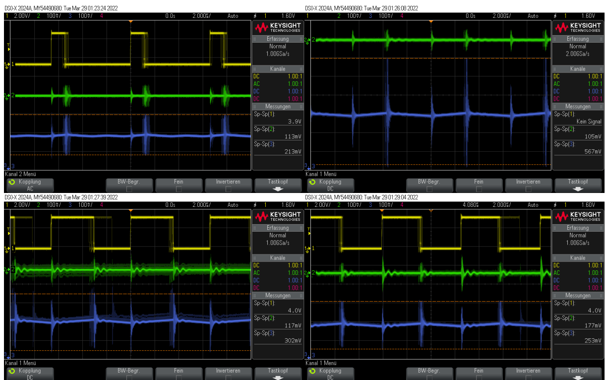
Abbildung 33: Messung der Spannungen an verschiedenen Punkten unter verschiedenen Betriebsbedingungen (Rev. 11.01.08) mit Eingangfilter-Induktivität: asynchron und ausgeschalteter Laststrom (oben links), synchron und ausgeschalteter Laststrom (oben rechts), asynchron und eingeschalteter Laststrom (unten links), synchron und eingeschalteter Laststrom (unten rechts).
