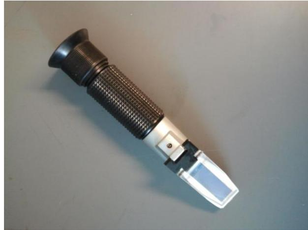
Abbildung 2.6: Refraktometer
