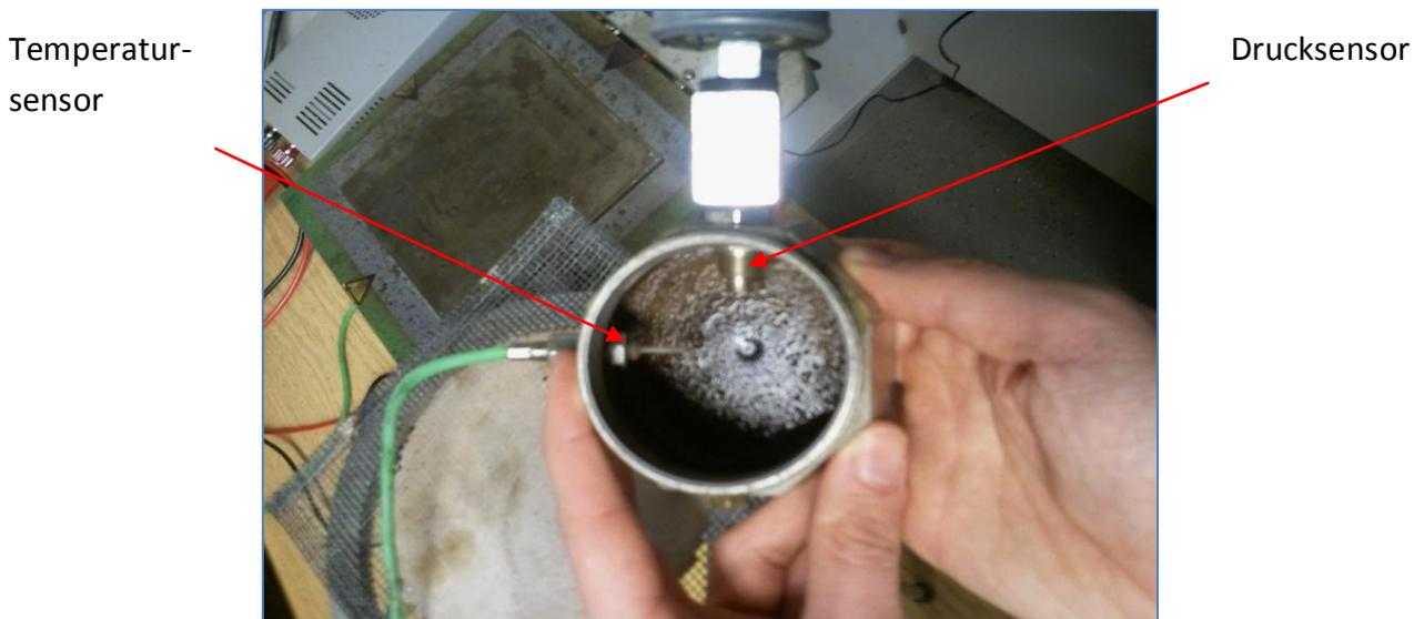
Abbildung 1: Wasserbehälter der Bialetti mit eingebauten Druck- und Temperatursensor
