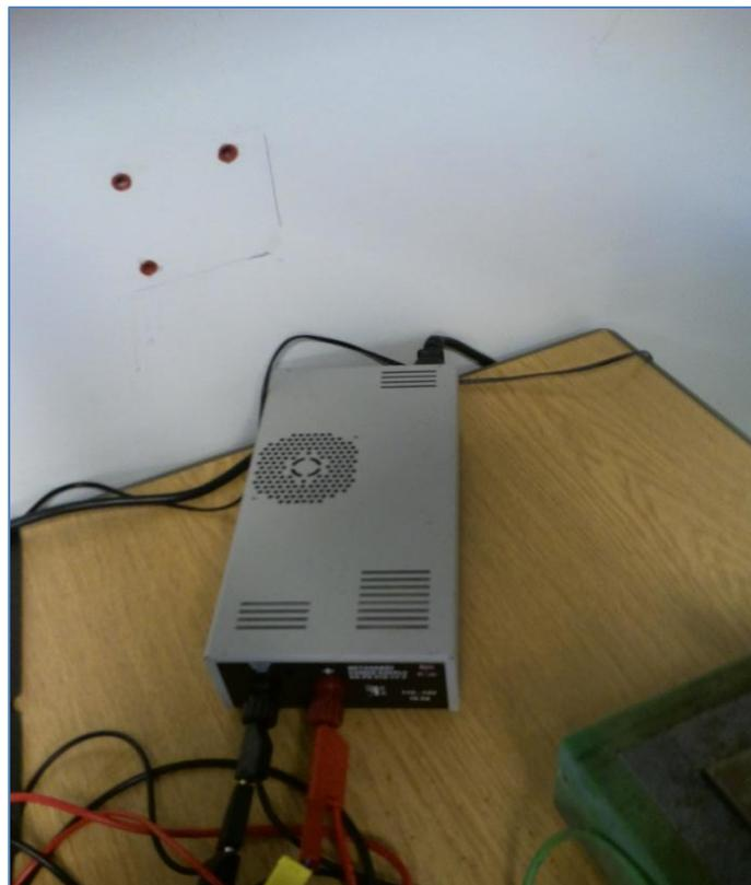
Abbildung 5: Netzgerät mit 12V DC Ausgangsspannung
