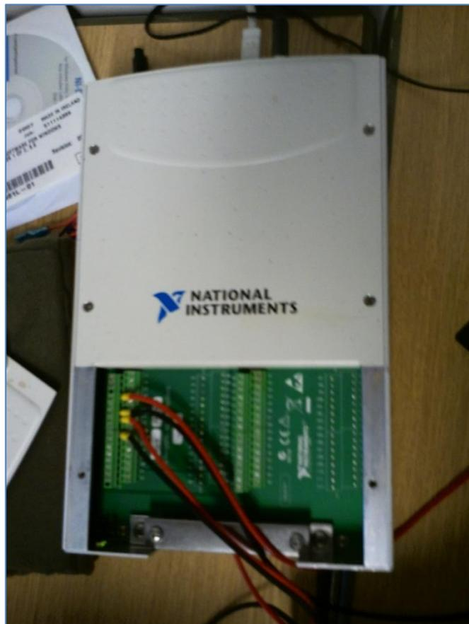
Abbildung 3: National Instruments Karte mit angeschlossenen Sensoren
