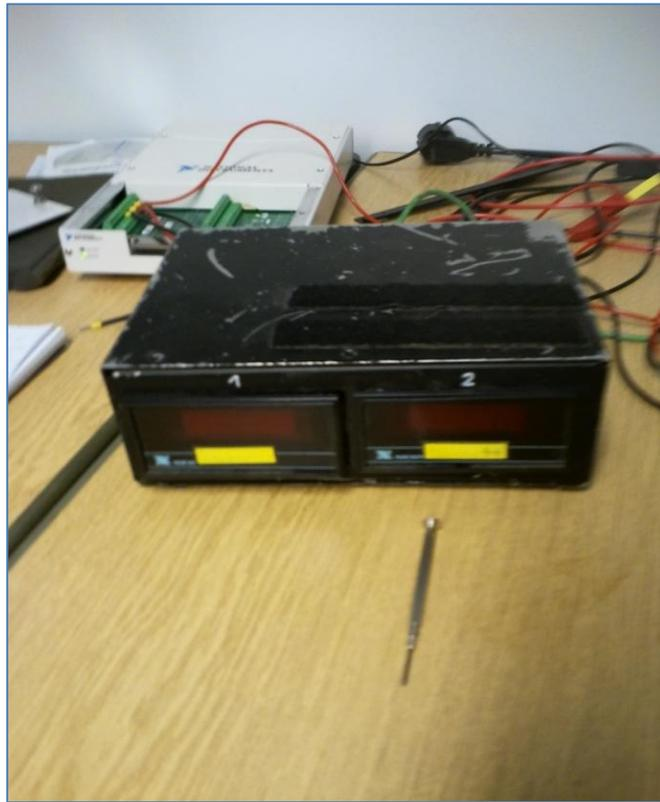
Abbildung 4: Messverstärker für den Ni-Cr-Ni -Temperatursensor
