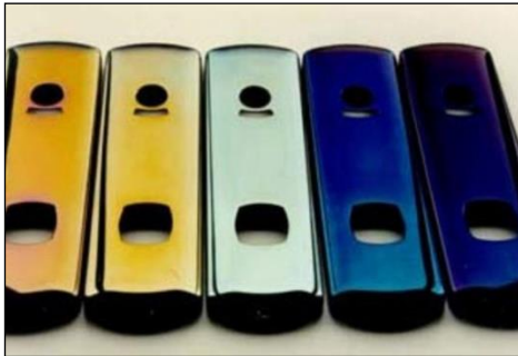
Abb. 8: Dekorative Schichten Beispiel: DLC-beschichtete Türbeschläge (DLC = Diamant like Carbon)
