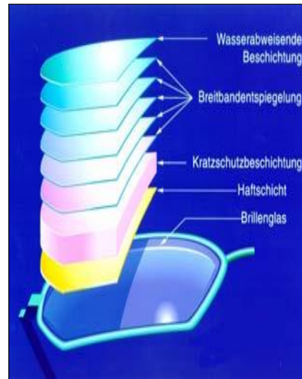
Abb. 9: Beschichtungen eines Brillenglases
