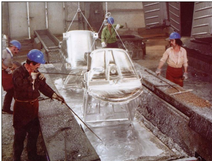
Abb. 56: Arbeit beim Stückverzinken
