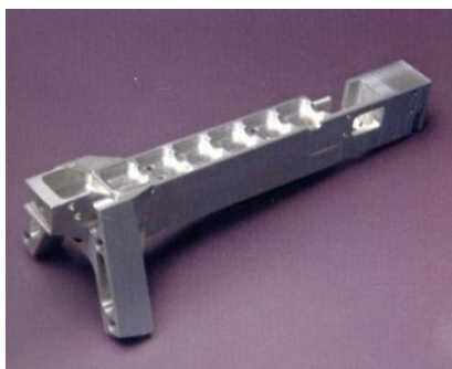
Abb. 148: Trägerarm eines Bestückungsautomaten (Steifigkeit hoch)
