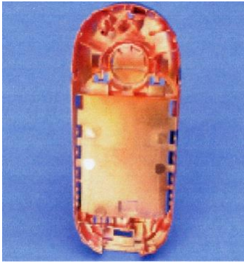
Abb. 99: PVD-metallisiertes Handygehäuse (elektromagnetische Abschirmung)
