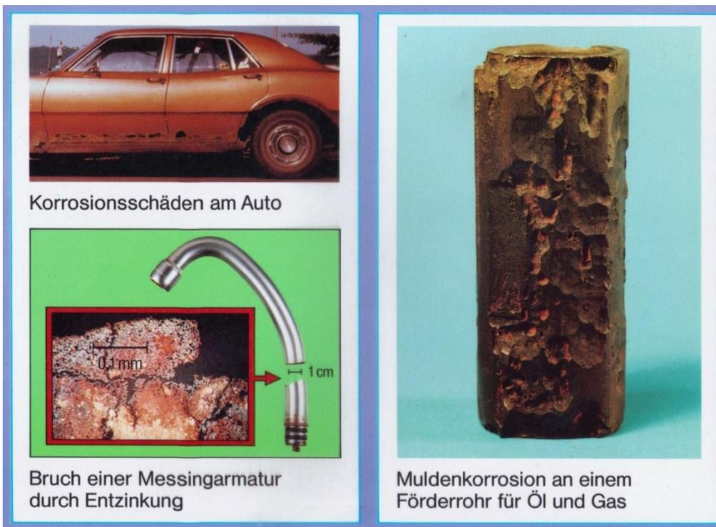
Abb. 67: Muldenförmige und örtliche Korrosion
