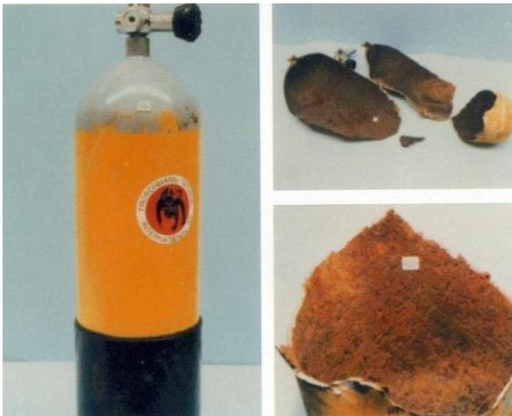
Abb. 68: Gleichmäßige Flächenkorrosion an einer Preßluft-Tauchflasche
