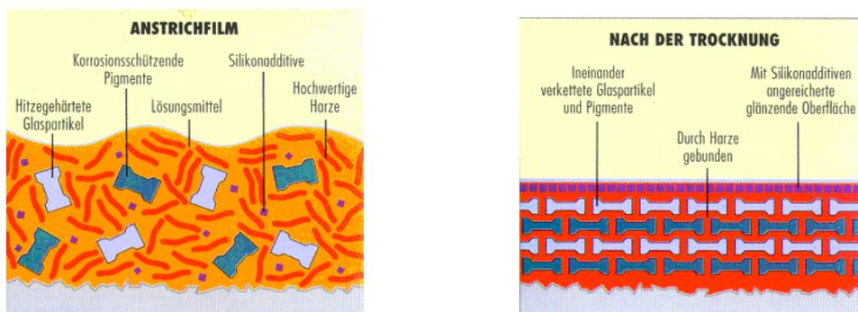
Abb. 204: Aufbau eines modernen „Metallschutzlacks“ (Hammerit), **Rostprimer** ist im Lack integriert a) beim Anstreichen und b) nach der Trocknung
