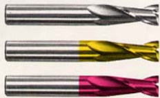
Bild 8: Vergleich der Standzeiten unbeschichteter und beschichteter Fräser.
