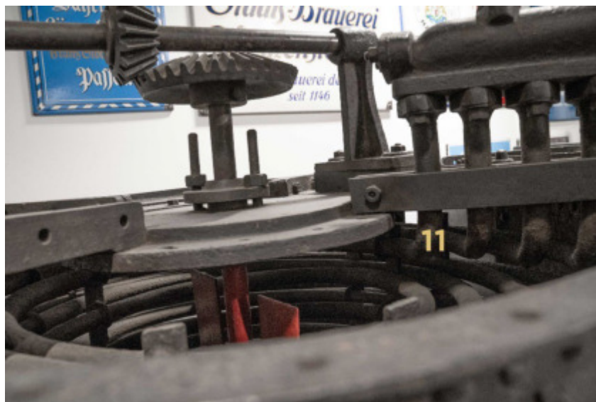
Kondensator mit Rührwerk
