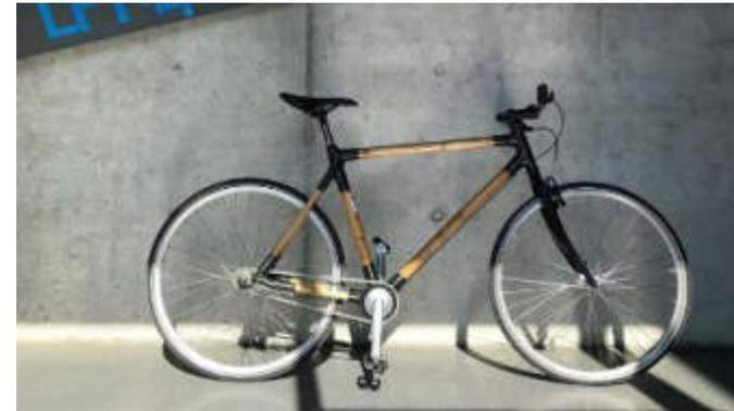
Bambusfahrrad mit CFK- oder NFK-Bauteilen
