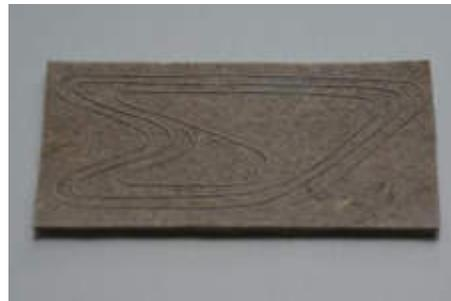
Belastungsgerechte Verstärkung mittels Tailored Fibre Placement (TFP)
