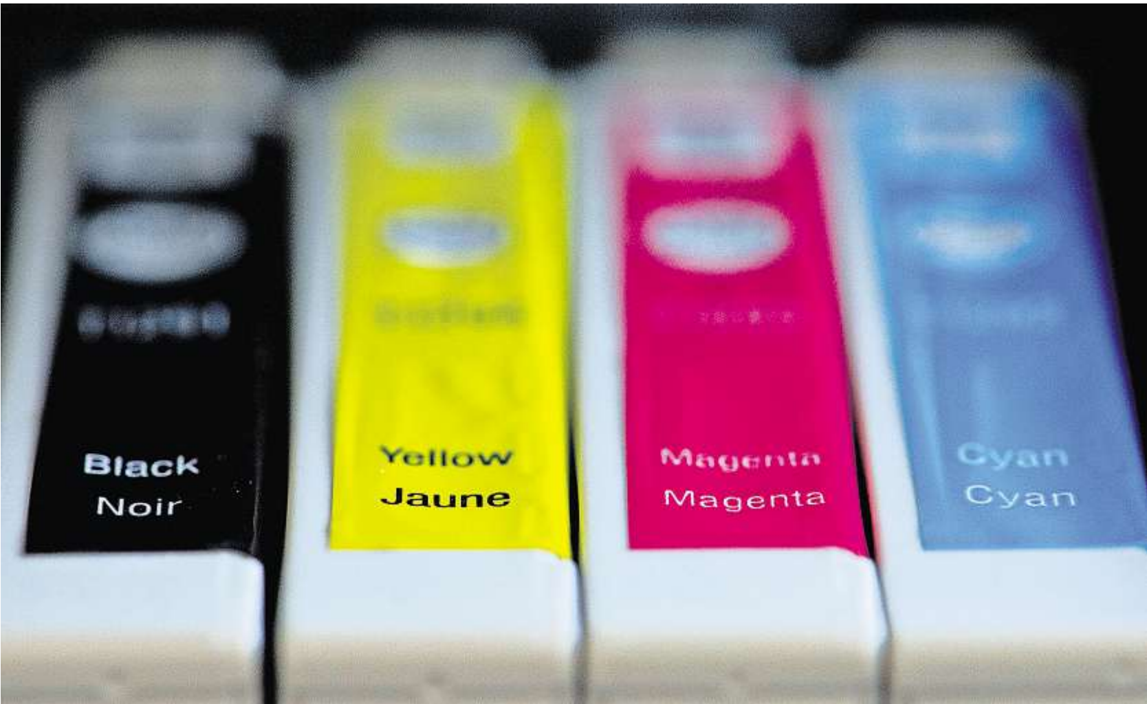
Die für den Farbdruck wichtigen drei Grundfarben Gelb, Magenta und Cyan. Manche Drucker haben neben dem normalen Schwarz auch noch eine Extra- patrone mit einem sogenannten Fotoschwarz. FOTO: ANDREA WARNECKE/DPA
