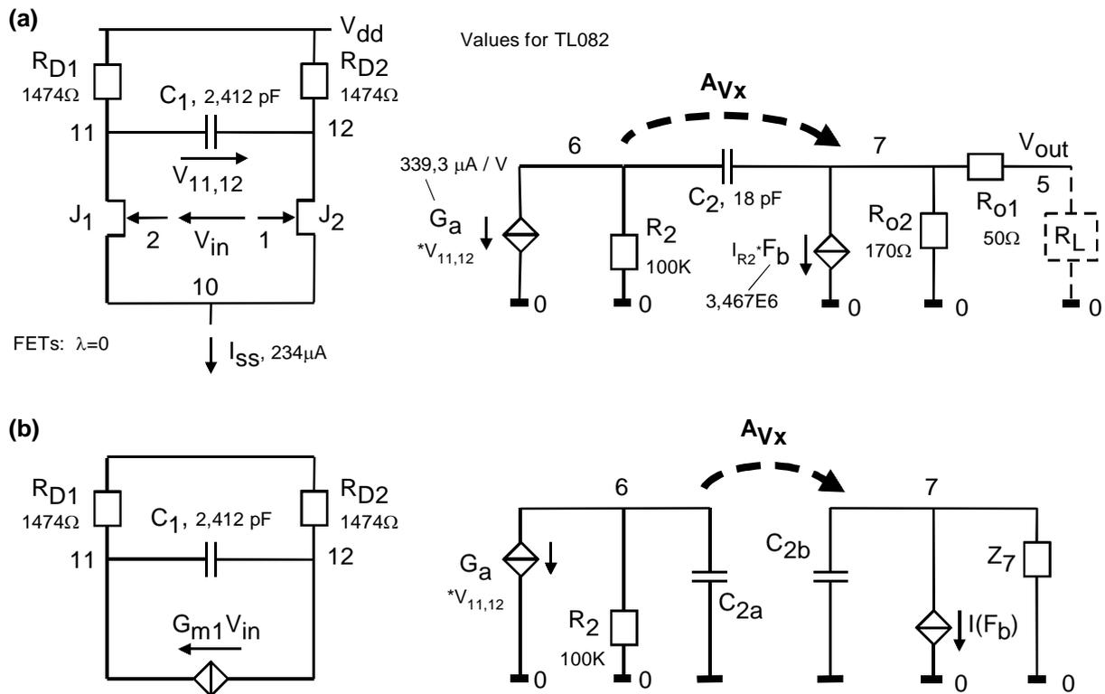
**Bild 5:** (a) Makro-Modell des OPs mit eingetragenen Kapazitäten  $C_1$  und  $C_2$ .
