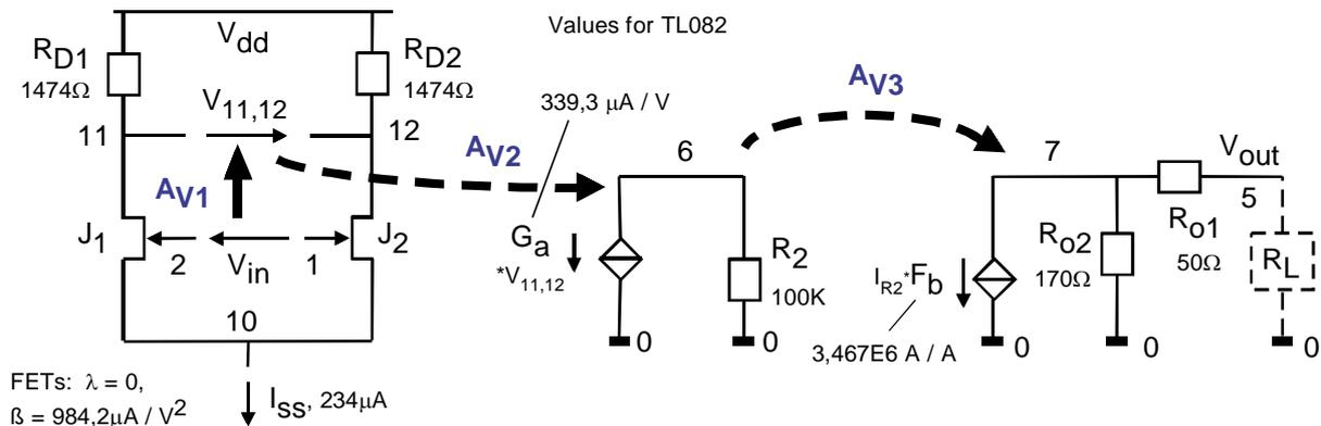
**Bild 4:** Übliches Makro-Modell für OP mit JFET-Eingang. Eine Zahl x bezeichnet einen Knoten x,  $V_x$  die Spannung auf dem Knoten x gegen Masse (=Knoten 0) und  $V_{x,y}=V_x-V_y$ .
