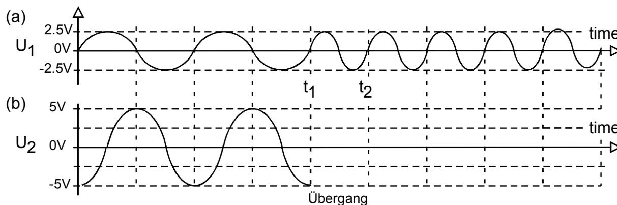
**Abbildung 1.4:** Veranschaulichung des Verstärkungs-Bandbreite-Produkts im Zeitbereich: (a) Eingangsspannung und (b) Ausgangsspannung des Netzwerkes in Abb. 1.3.
