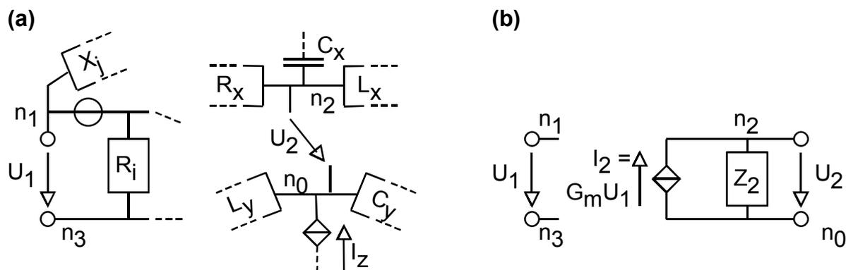
**Abbildung 1.1:** (a) Beliebiges Netzwerk mit  $U_2=f(U_1)$ , (b) reduziertes Netzwerk
