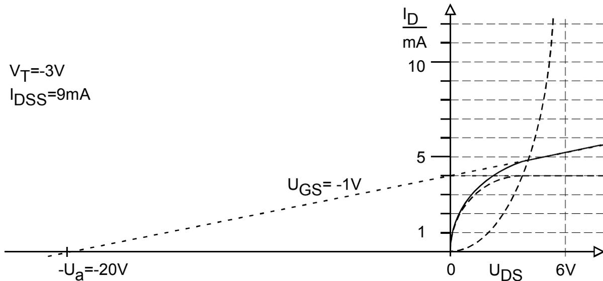
**Abbildung 2.2:** Ausgangskennlinienfeld eines n-Kanal-FETs mit  $V_T = -3V$  und  $I_{DSS} = 9mA$ .
