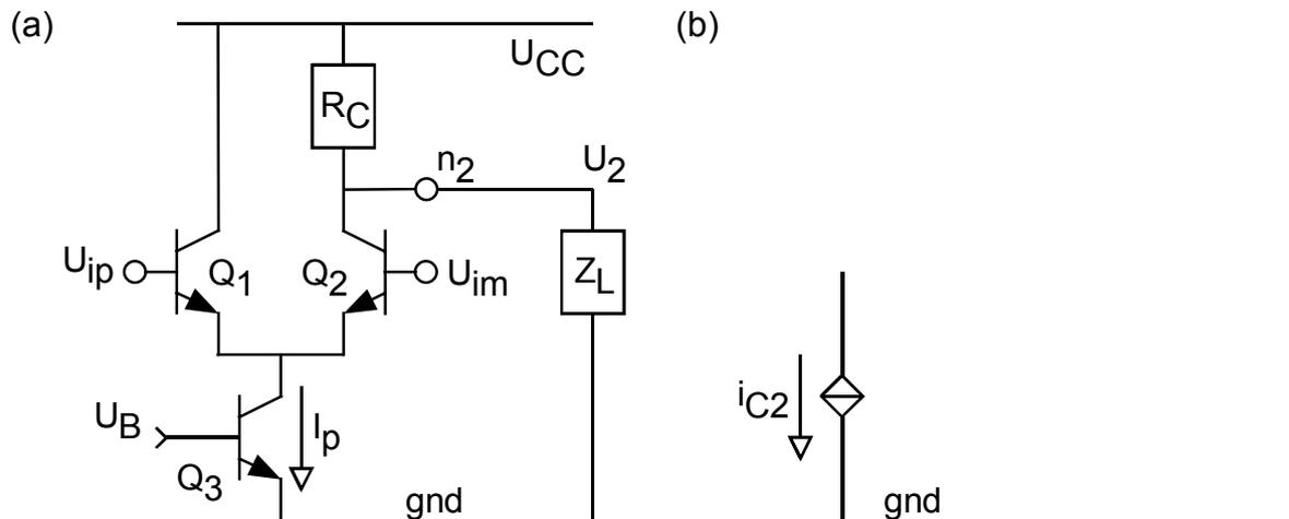
Abbildung 3: (a) Differenzieller Verstärker, (b) Kleinsignal-ESB für den Ausgangsknoten.
