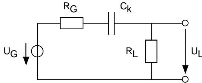
Gegeben seien  $R_G$ ,  $R_L$  und  $f_{gu}$ . Gemäß Abb. 1.1 Berechnen Sie den Koppelkondensator  $C_k$  so, daß ein Pol in  $f_{gu}$  entsteht. Die Herleitung muß nachvollziehbar sein. (3P)
