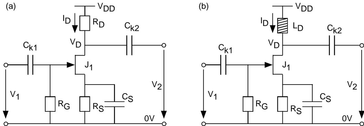
Abbildung 3: JFET - Verstärker: (a) mit Drain-Widerstand und (b) mit Induktivität
