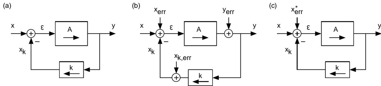
**Abbildung 4.1:** Regelsystem: (a) ideal, (b) mit Fehlerquellen, (c) alle Fehlerquellen zusammengefaßt in äquivalenten Eingangsfehler  $x_{err}^*$ .
