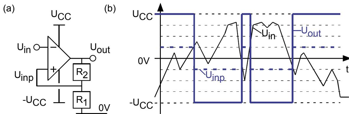
Abbildung 5.2: (a) Komparator mit Operationsverstärker und (b) Schaltverhalten
