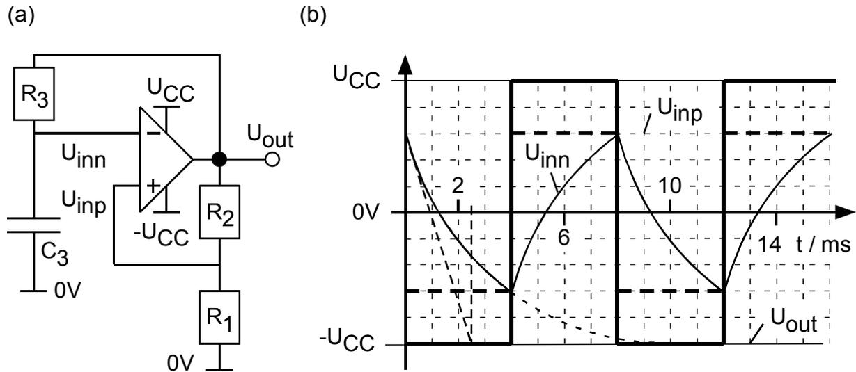
**Abbildung 5.3:** Oszillator mit Operationsverstärker
