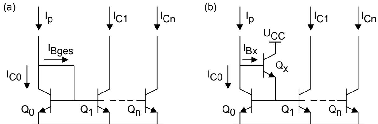
**Abbildung 4.1:** (a) Mehrfachspiegelung, (b) Mehrfachspiegelung mit Puffer-Transistor
