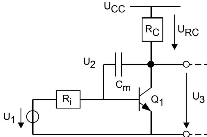
Die Schaltung in Abb. 3.2 habe eine Verstärkung von  $|A_v|=200$ . Für  $R_i = 220 \Omega$  soll durch  $R_i$  und die nachfolgende kapazitive Last ein Pol in  $f_{p1} = 1 \text{ KHz}$  entstehen.
