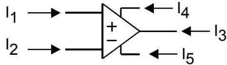
Wie groß ist die Summe aller Ströme in eine Schaltung aus diskreten Komponenten, z.B. den OP in Abb. 2.4 ? (Es bestehen keine galvanischen Verbindungen oder kapazitive Kopplungen zum Umfeld der Schaltung als den eingezeichneten.)
