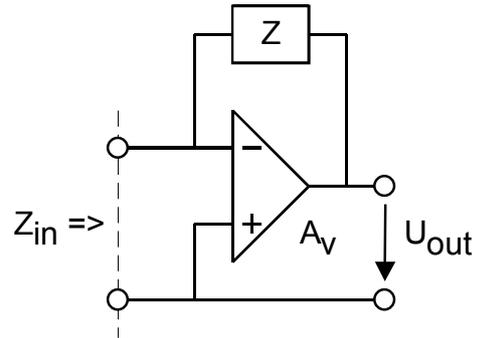
Der Operationsverstärker in Abb. 5.4 sei ideal bis auf eine endliche Verstärkung  $A_v$ . Wie groß ist die Eingangsimpedanz der gezeigten Schaltung ? (1P)
