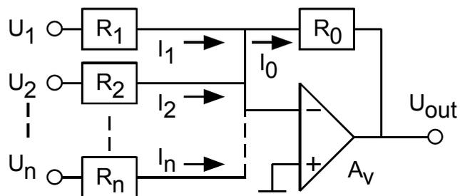
Gegeben ist der Summierer in Abb. 5.5 mit  $A_v \rightarrow \infty$ , n Eingangsspannungen und n Eingangswiderständen  $R_k$ . Welche Eingangsimpedanz  $Z_k$  belastet die Spannungsquelle  $U_k$  ( $k=1 \dots n$ ) ? (1P)
