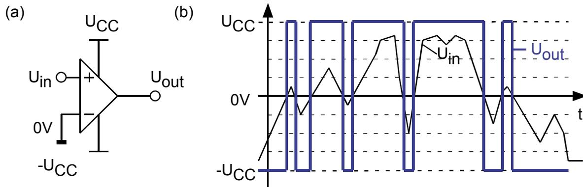
Abbildung 5.1: (a) Komparator mit Operationsverstärker und (b) Schaltverhalten
