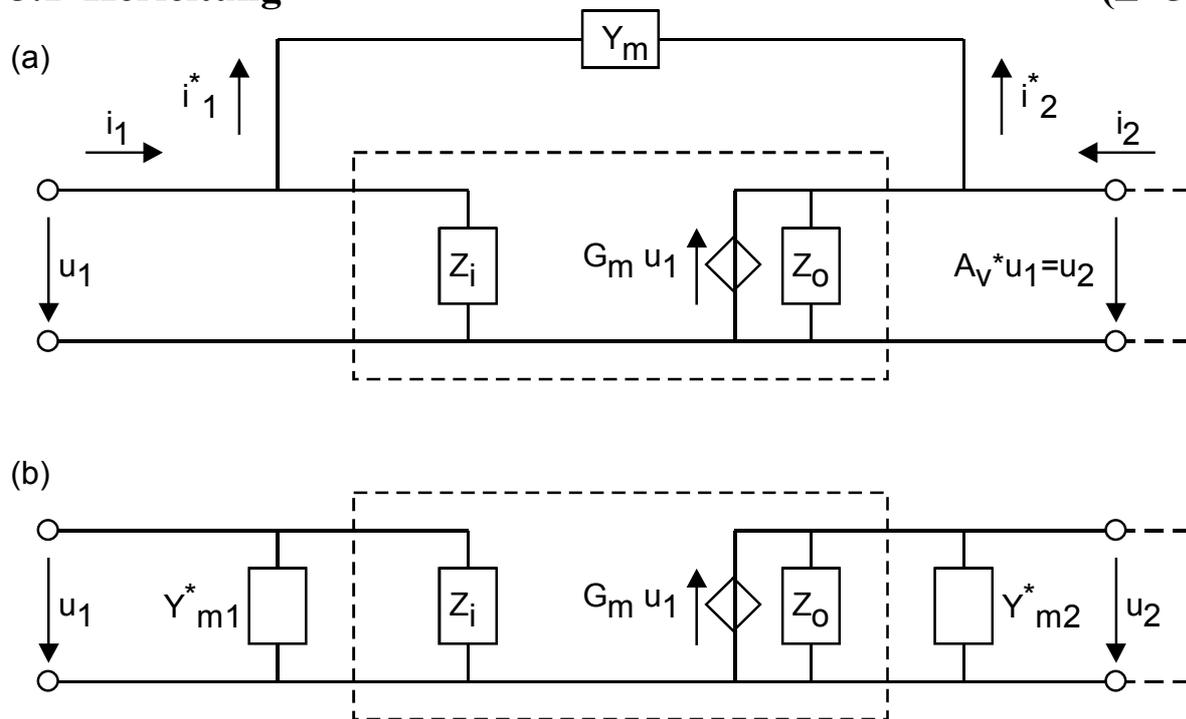
**Abbildung 3.1:** (a) Leitwert  $Y_m$  über einem Schaltungsteil mit  $u_2 = A_v u_1$ ,
