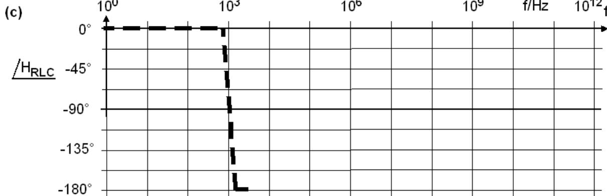
**Fig. 1:** (a) RLC-Tiefpass mit  $L = 32 \mu\text{H}$ ,  $R_D = 30 \text{ m}\Omega$ ,  $C = 800\mu\text{F}$ ,  $R_C = 2 \text{ m}\Omega$ ,  $L_p = 3,2\text{pH}$
