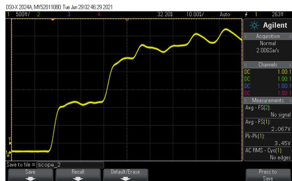
**Bild 6 (a):** Messaufbau, **(b)** Schalter S offen: Messung an  $n_2$  ohne  $TLine2$  und  $TLine3$ . **(c)** Nach Schließen von Schalter S: Zusätzliches 20ns breites 1,43V-Plateau in der Flanke.
