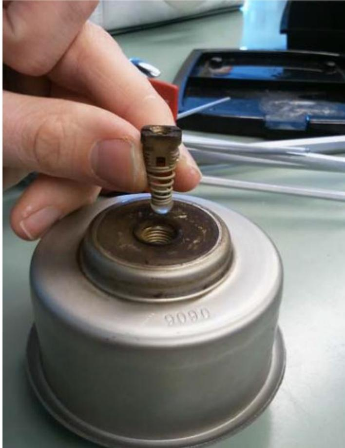
Abbildung 6: Unterseite des Kessels mit der Kugel und Feder
