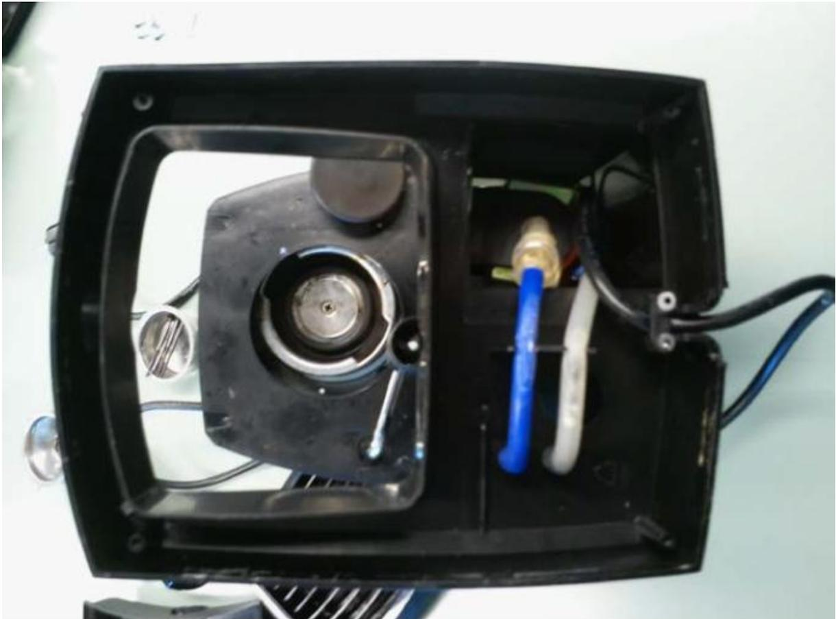
Abbildung 3: Unterseite der Siebträgermaschine nach Abnahme der Bodenplatte
