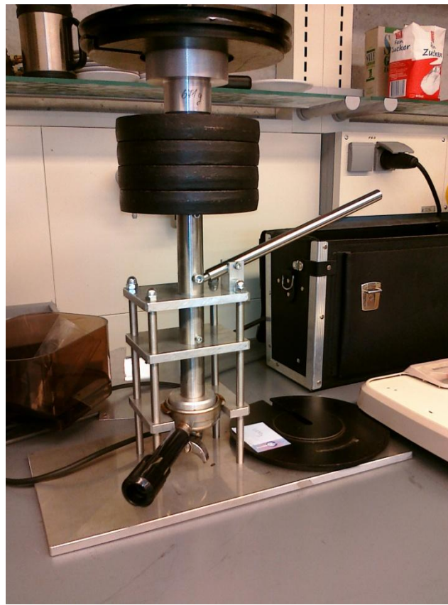
Abbildung 4: Tamperdruckanlage mit Gewichten und eingehängtem Siebträger
