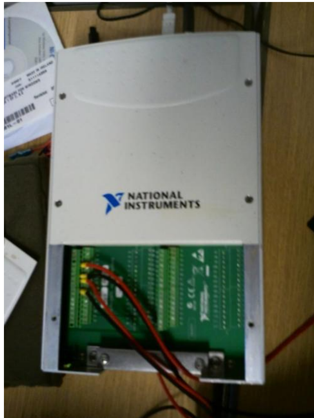
Abbildung 3: National Instruments Karte mit angeschlossenen Sensoren
