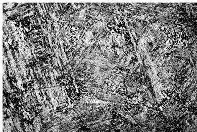
Bild 1. X20 CrMoV 12 1, normaler Gefügestand (N) nach Betriebsbeanspruchung, V = 200 fach.
