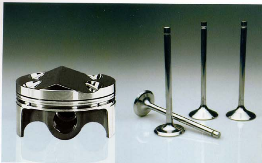
Bild 4: Warmumgeformte Bauteile. Links: Geschmiedeter Kolben aus sprühkompaktiertem MDS20 (AlMg17Si8Cu2), Materialdichte 2,54 g/cm 3 . Rechts: Fließgepresste Ventile aus DISPAL®S250 (AlSi20Fe5Ni2).
