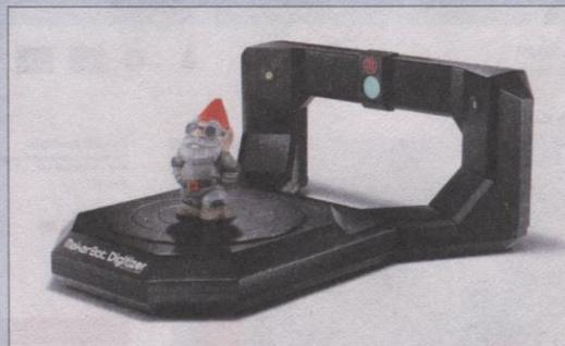
**3D-Scanner:** Das Objekt wird auf einem Drehteller von zwei Laserstrahlen abgetastet, eine Kamera erfasst die Daten (Bild I)
