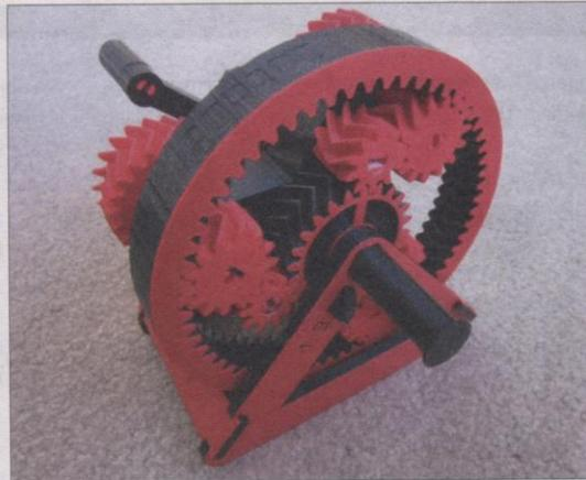
**Transmissionsmaschine:** Die Teile des automatischen Getriebemodells müssen nach dem Druck nur noch zusammengesteckt werden (Bild C)
