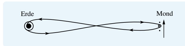
Abbildung 4.5: Nominale Apollo Trajektorien, skizziert ohne die Berücksichtigung der orbitalen Geschwindigkeit des Mondes um die Erde (1 km/h). Jene orbitale Geschwindigkeit des Mondes macht die Berechnung der Trajektorien noch komplizierter. [56]
