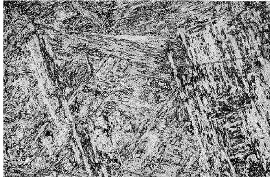
**Bild 11. X20 CrMoV 12 1: normaler Gefügezustand nach Betriebsbeanspruchung, V = 200fach.**
