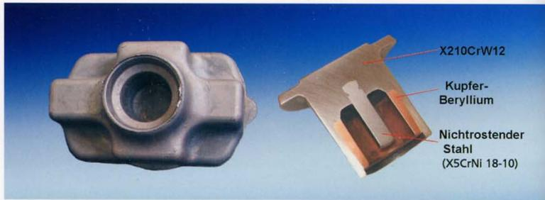
Bild 5: Thixogeschmiedetes Pumpengehäuse aus 100Cr6, Thixojoining-Demonstrator aus X210CrW12 mit diversen gefügten Metallen. Bilder: IBF RWTH Aachen
