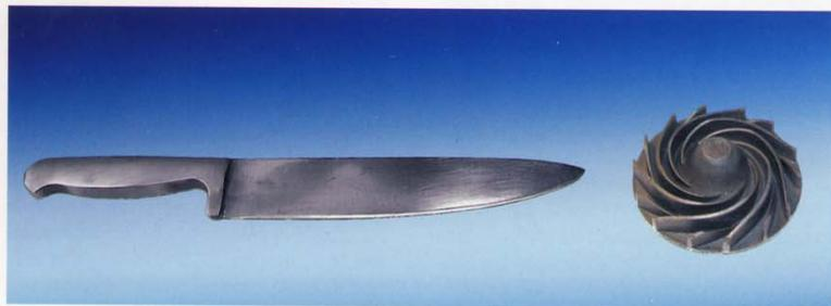
Bild 4: Thixogegossenes Messer und Impeller (Werkstoff X210CrW12).
