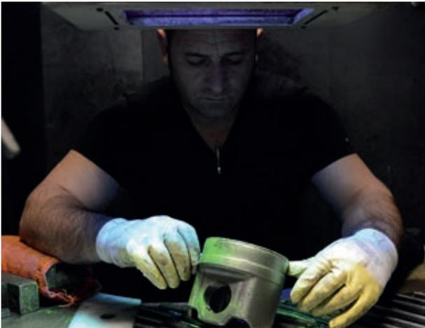
Bild 11.7: Blick in eine Fluxkabine
