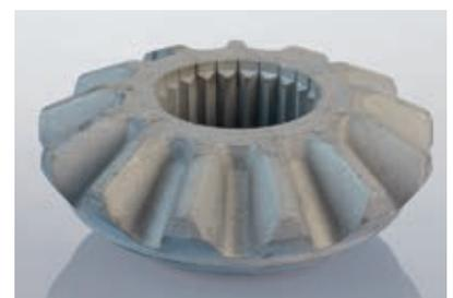
unterzogen werden, erfolgen eine relativ sanfte Reinigung der Oberfläche durch Strahlen (Kapitel 6.9) und die abschließende mechanische Hartbearbeitung der Kegelradkalotte.
