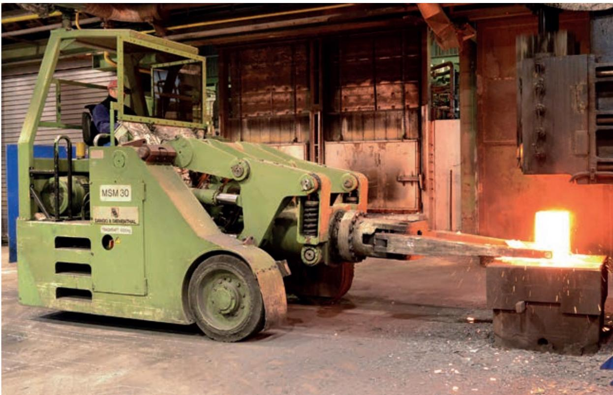
Bild 7.38: Manipulator zur Handhabung der Werkstücke
