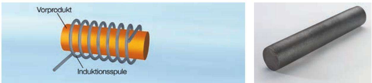
Bild 7.4: Erwärmungsprozess: Induktive Erwärmung
