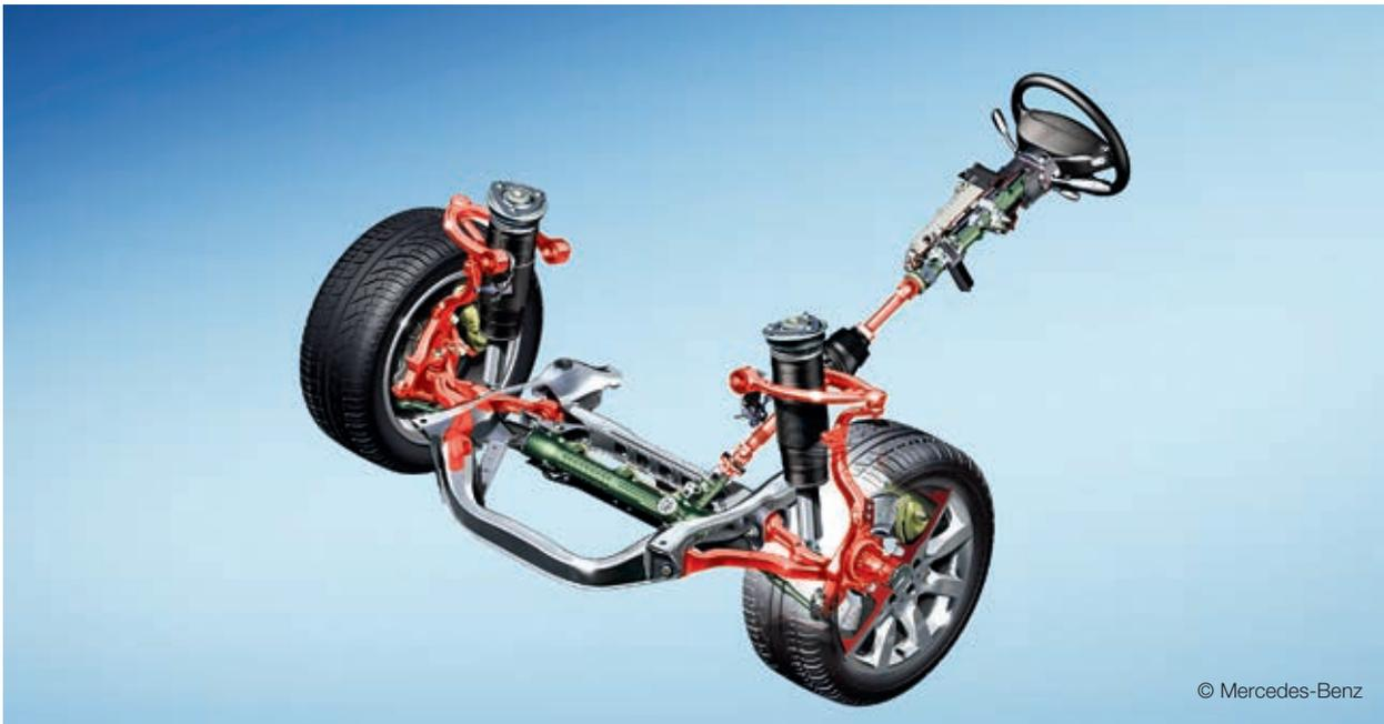
Bild 2.11: Mercedes-Benz SL-Vorderachse mit Lenksäule
