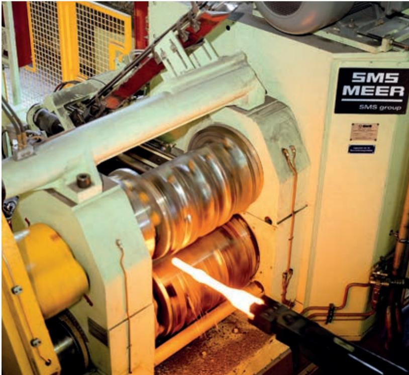
Bild 8.9: Reckwalze mit 4 Walzsegmenten
