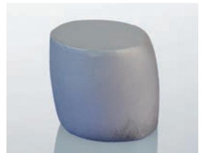
Bild 7.25: Erster Schritt von Umformprozess 1: Entzundern durch Parallelstauchen
