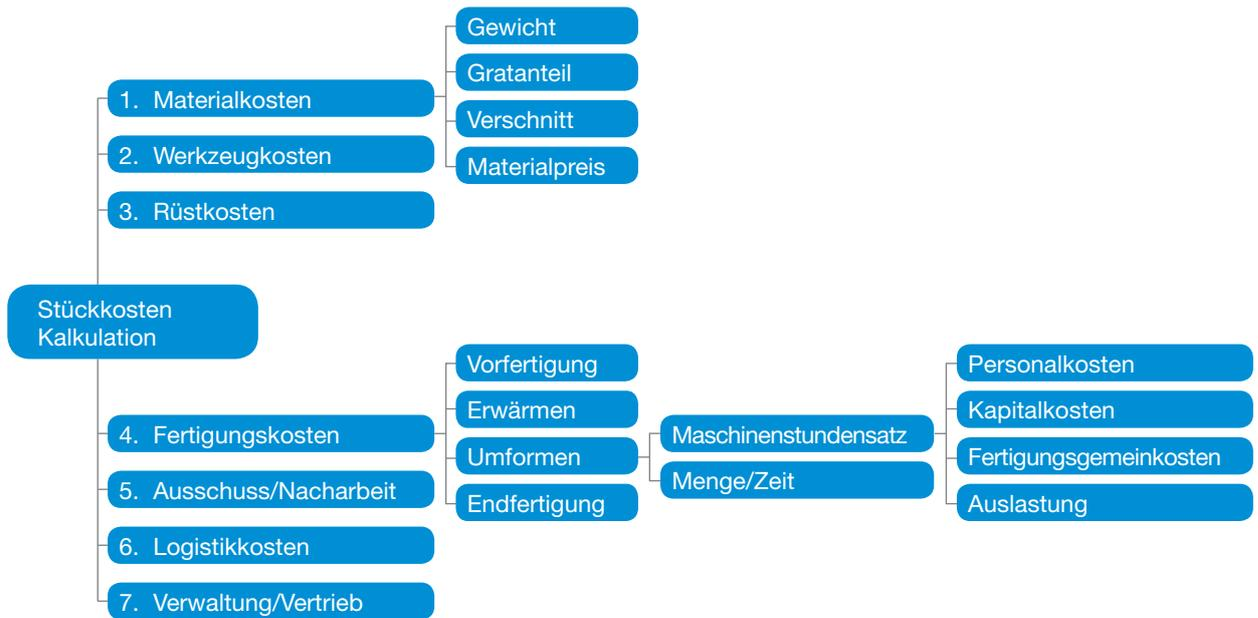
Bild 13.2: Schema einer Stückkostenkalkulation
