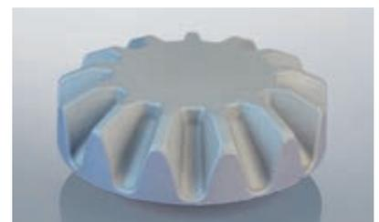
Bild 7.26: Zweiter und dritter Schritt von Umformprozess 1: Gesenkschmieden ohne Grat.
