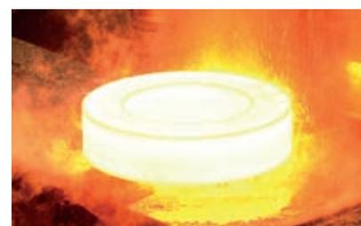
Bild 7.41: Zweiter Umformprozess: Ringwalzen
