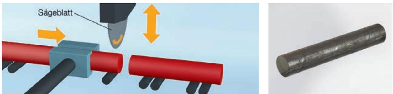
Bild 7.15: Erster Schritt der Vorfertigung: Sägen
