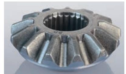
Bild 7.31: Erster Schritt der Endfertigung: Mechanische Bearbeitung bei weichem Werkstoffzustand
