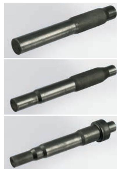
Bild 7.18: Umformprozesse: Fließpressen in 3 Stufen
