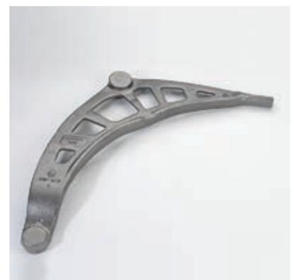
Bild 7.9: Fünfter Schritt des Umformprozesses: Abgraten und Lochen
