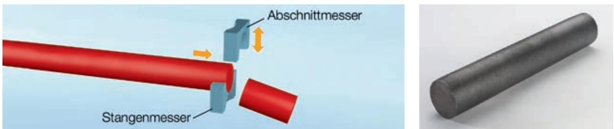
Bild 7.3: Vorfertigungsprozess: Kaltscheren
