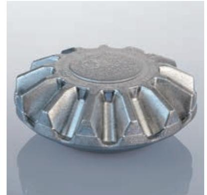
Bild 7.30: Umformprozess 2: Kalt-Kalibrieren
