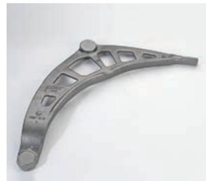
Bild 7.11: Zweiter Schritt der Endfertigung: Reinigungsstrahlen
