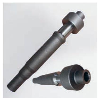
Bild 7.21: Dritter Schritt der Endfertigung: Mechanische Bearbeitung
