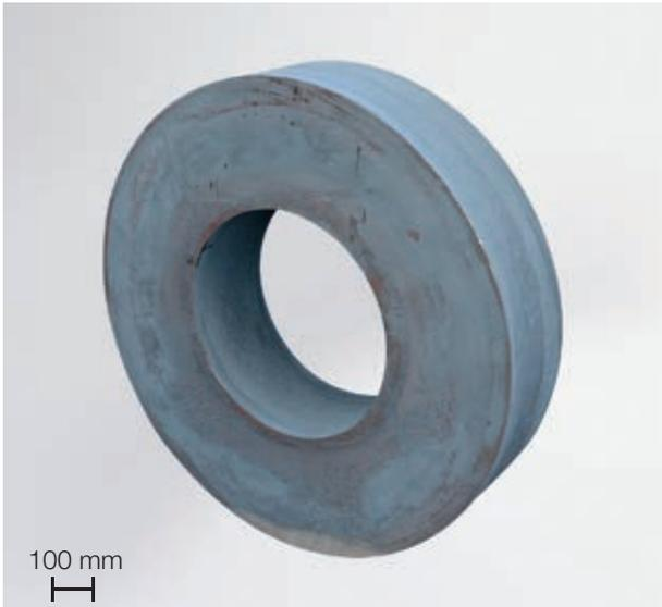
Bild 10.4: Rohteil für ein Zahnrad ( $m = 1.300 \text{ kg}$ )
