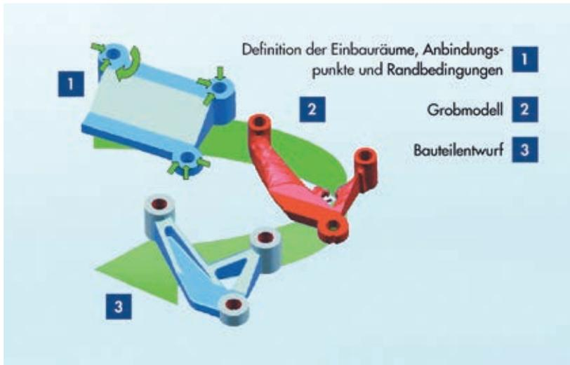
Bild 12.2: Schematischer Ablauf einer Topologieoptimierung
