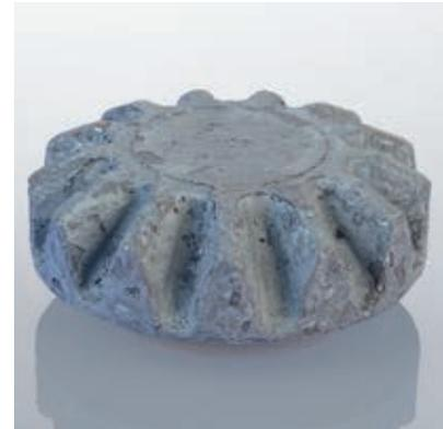
Bild 7.27: Erster Schritt der Zwischenfertigung: Wärmebehandeln
