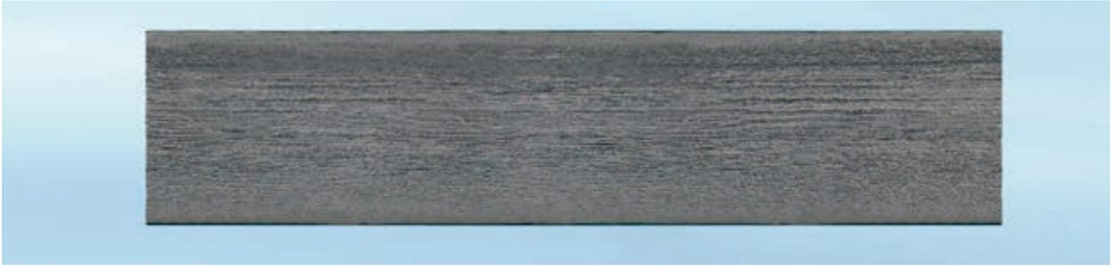
Halbzeug (Schnittdarstellung) mit ausgerichtetem Faserverlauf
