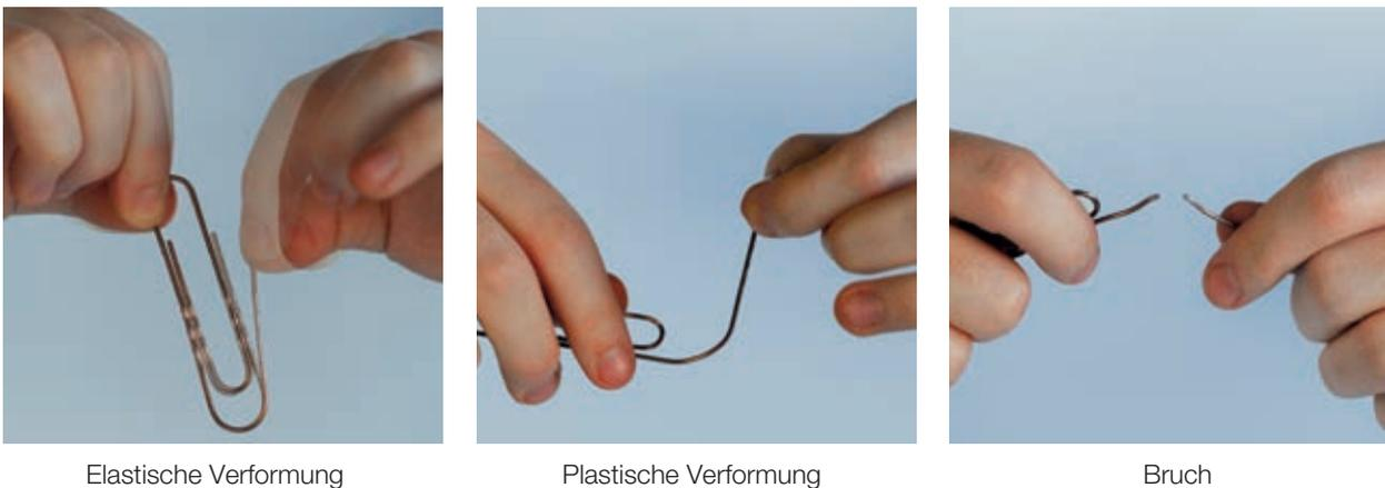
Diese metallischen Eigenschaften lassen sich durch Versuche ermitteln. Wird beispielsweise bei einem Zugversuch die zur Verformung benötigte Spannung über der Dehnung in einem Diagramm aufgetragen, dann erkennt man die für die metallischen Werkstoffe verschiedenen charakteristischen Bereiche (Bild 3.1):
