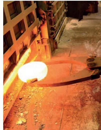
Bild 7.40: Erwärmungsprozess: Indirekte Erwärmung
