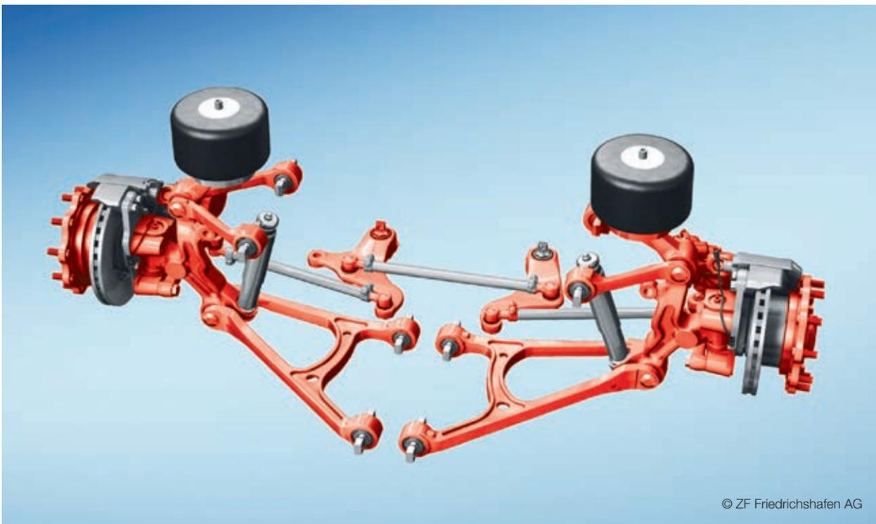
Bild 2.12: Einzelradaufhängung für Busse
