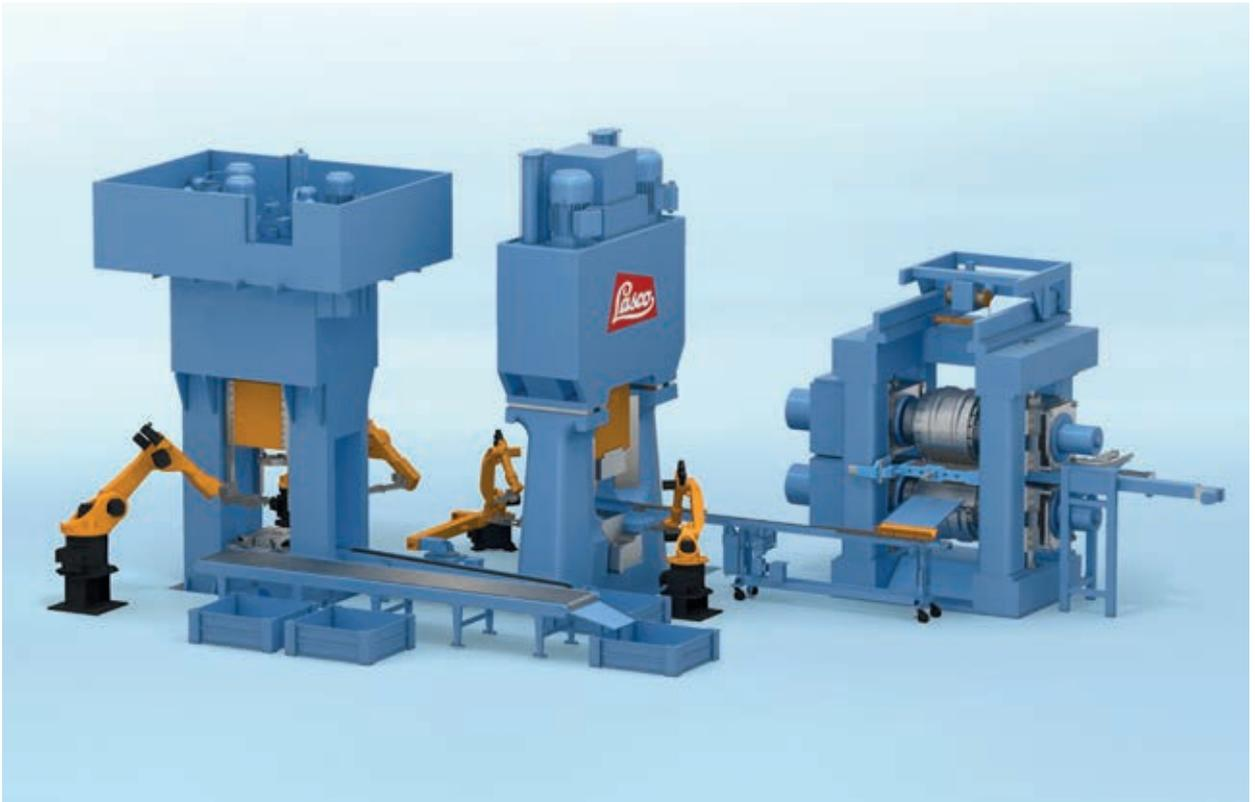
Bild 8.13: Schematische Darstellung einer Anlagenautomatisierung durch Robotersysteme
