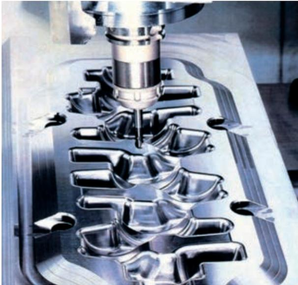
Für das Fräsen der Gravur oder der Elektrode ist ein NC-Programm erforderlich. Dieses NC-Programm wird über ein CAM-Modul (**C**omputer **A**ided **M**anufacturing) erstellt, Grundlage dafür ist das CAD-Modell der Gravur (siehe Kapitel 12).
