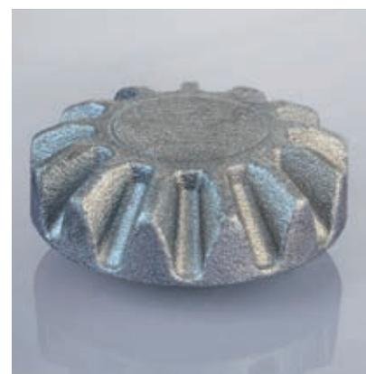
Bild 7.29: Dritter Schritt der Zwischenfertigung: Beschichten
