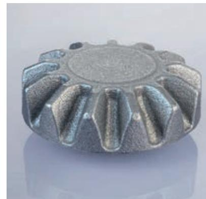
Bild 7.28: Zweiter Schritt der Zwischenfertigung: Reinigungsstrahlen
