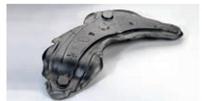
Bild 7.8: Vierter Schritt des Umformprozesses: Gesenkschmieden mit Grat
