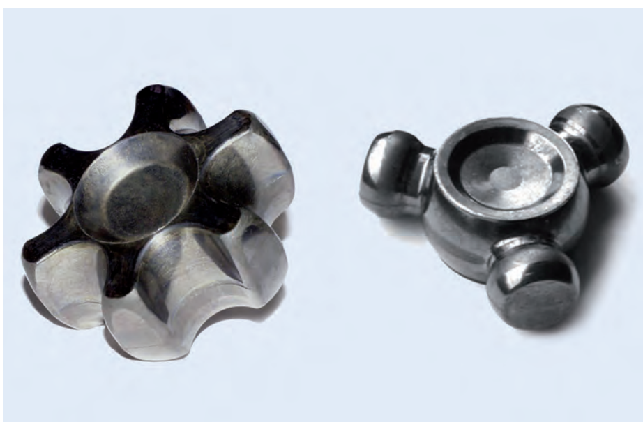
Bild 3: Kugelnabe [LIE09] und Trisphär [LAN08], hergestellt in geschlossenen Werkzeugen als Beispiele für lauwarmumgeformte Bauteile.
