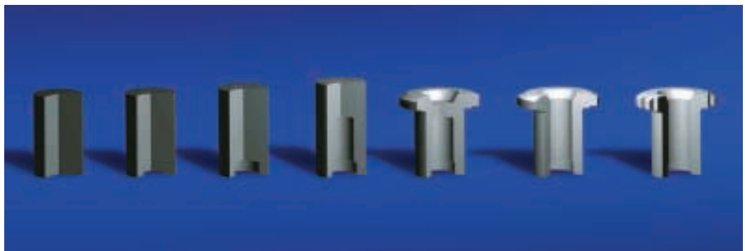
Bild 3: Stadienfolge zur Herstellung eines hohlen Kaltfließpressteils mit Verzahnung
