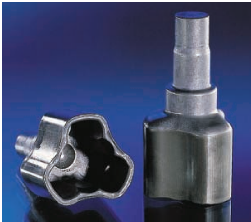
Bild 13: Durch die Kombination aus Halbwarm- und Kaltmassivumformung hergestellte Tripodenwelle
