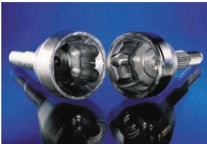
Bild 14: Durch die Kombination von Halbwarmfließpressen und Kaltkalibrieren hergestelltes Gelenkwellenteil (links Rohteil, rechts fertig bearbeitet)
