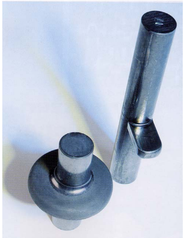
Bild 1: Halbwarmumformung von Stahl: Getriebe- und Schaltwelle
